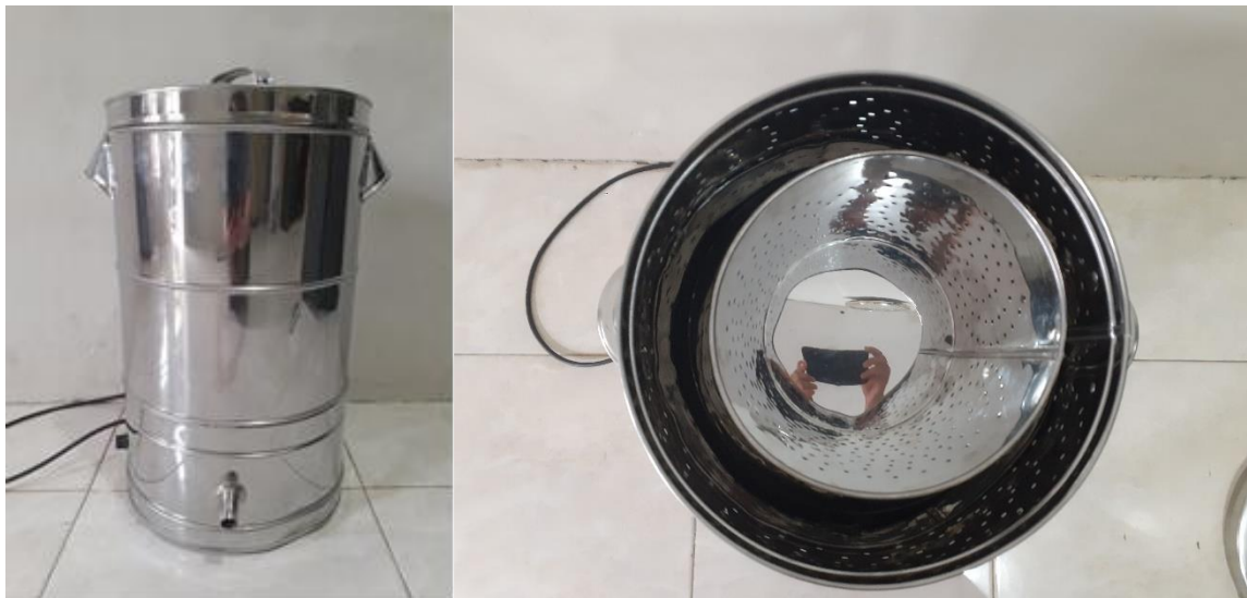
Gambar 3. Alat peniris minyak otomatis yang dapat menggantikan metode penirisan konvensional
